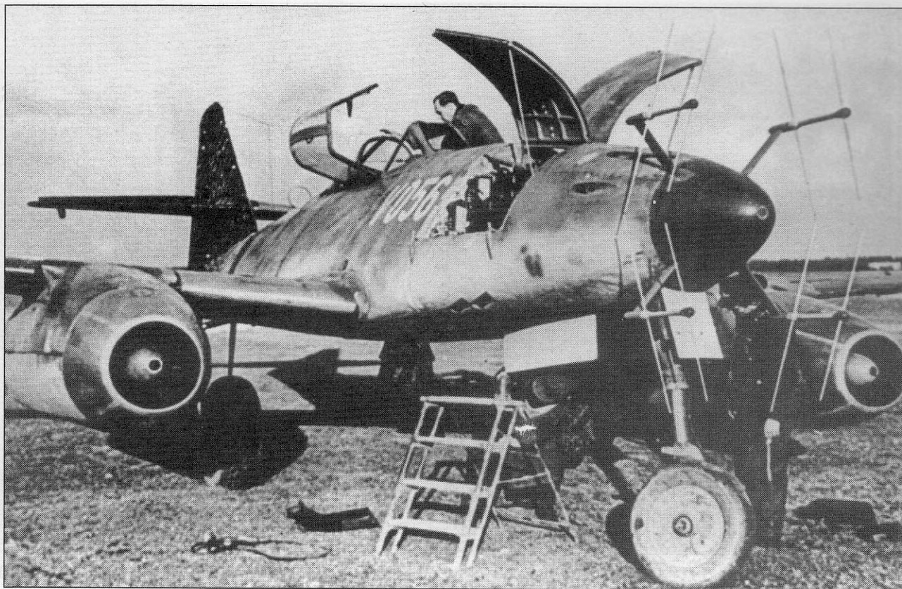
Me 262 A-1a (W.Nr. 170056, иначе V056) во время тестов с радарными антеннами для ночного истребителя.
