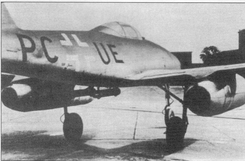
Тот же самолет с ракетными стартовыми ускорителями Borsig RI-502, июнь 1943 г.
