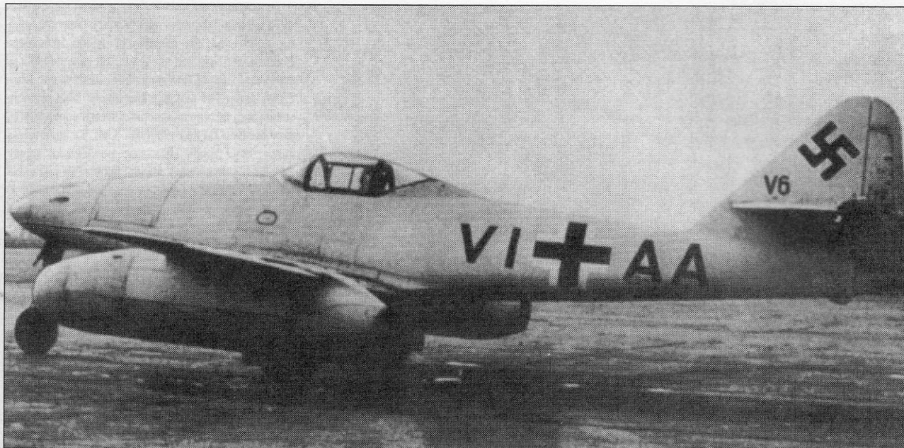
Me 262 V6 (W.Nr. 130001, VI+AA) в другом ракурсе. Обращает внимание - пилотская кабина старого образца.
