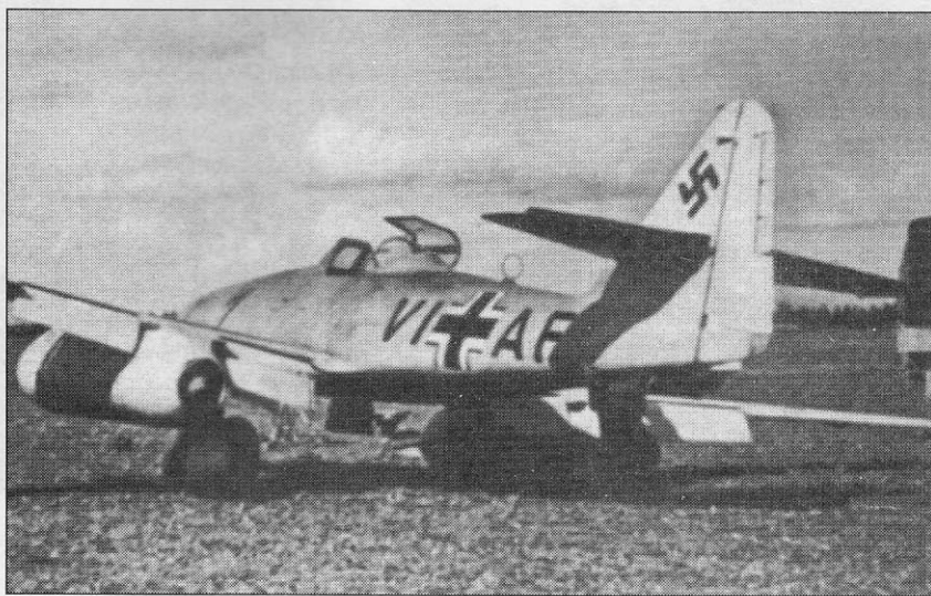
Me 262 S1 (VI+AF) - первый предсерийный экземпляр после поломки шасси 11 июня 1944 г.
