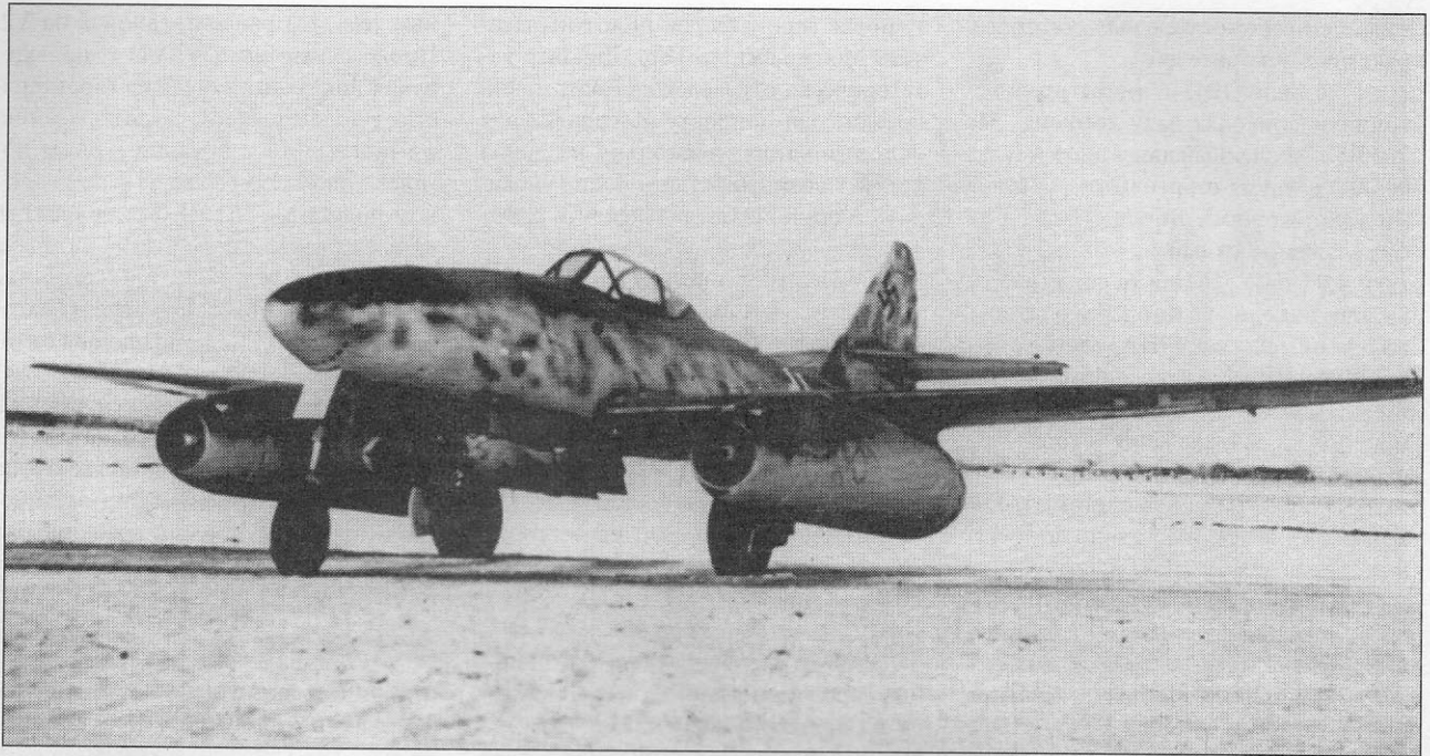
Me 262 A-1a/Jabo с двумя бомбами SC 250 на бомбодержателях «Wikingenschiff».
