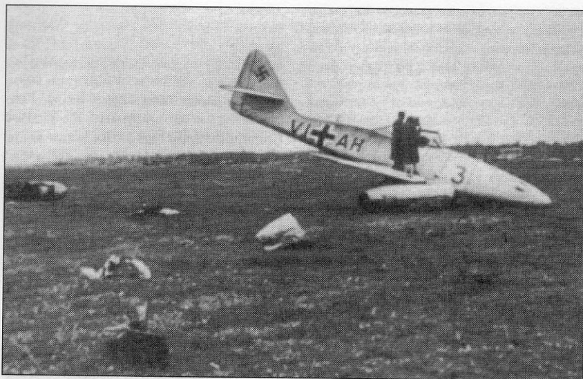
Me 262 S3 (VI+AH) со сломанной передней стойкой шасси.
